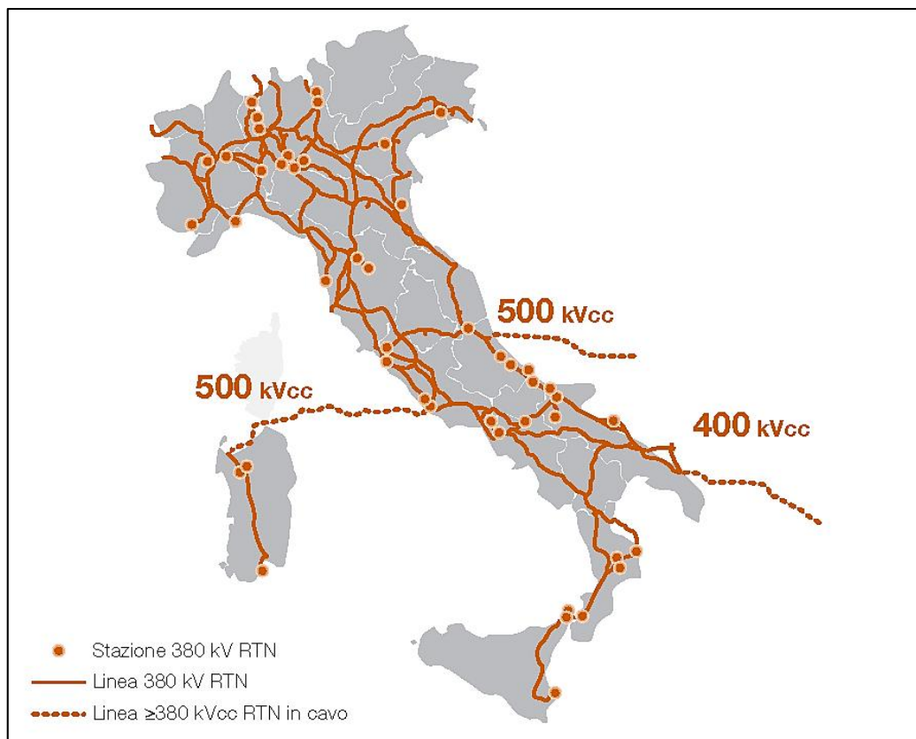
Figura 7-24 Distribuzione della rete a 380 kV e dei collegamenti HVDC Sardegna-Penisola Italiana (cd. SA.PE.I.), Grecia-Italia (cd. GR.ITA.) e Montenegro-Italia (cd. MonIta), da Terna "Piano di sviluppo della Rete 2021"
