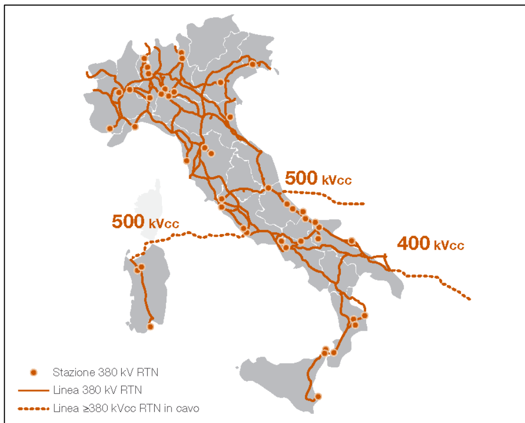
Figura 6-33 Distribuzione della rete a 380 kV e dei collegamenti HVDC Sardegna-Penisola Italiana (cd. SA.PE.I.), Grecia-Italia (cd. GR.ITA.) e Montenegro-Italia (cd. MonIta), da Terna "Piano di sviluppo della Rete 2021"
